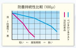
試験ハウスによる比較評価(展張後1.5年)
