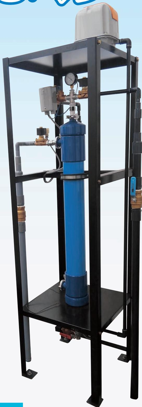
0.01 $\mu$ mのフィルター (UF膜) を使用。
