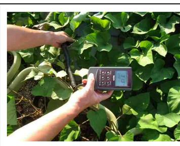
放射温度計による葉の下のコンクリート面温度調査
