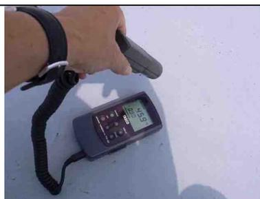
放射温度計によるコンクリート面温度調査
